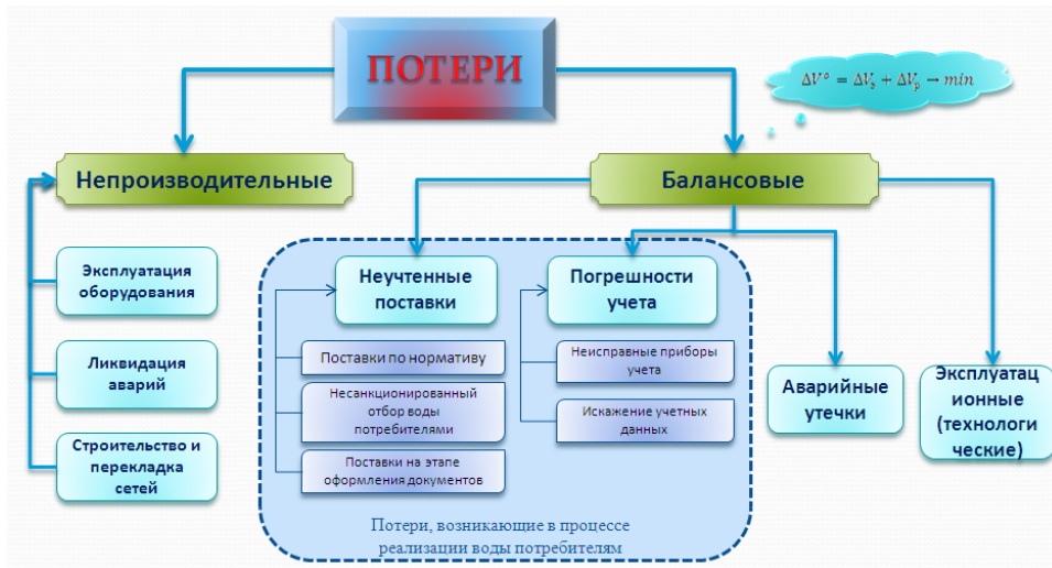
Рис. 2. Обобщенная структура источников потерь в системе водоснабжения
