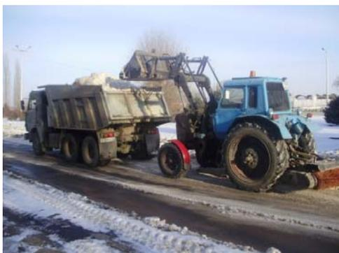
Рис. 8. Линейная погрузка
