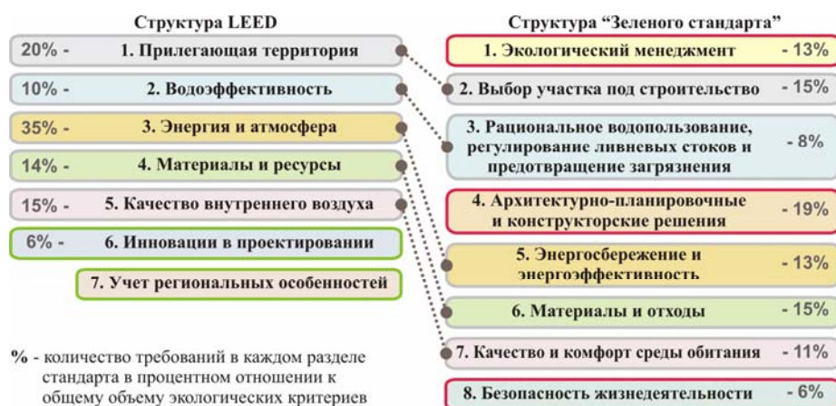
Рис. 2. Авторский сравнительный анализ разделов американского экологического стандарта LEED и российского «Зеленого стандарта»
