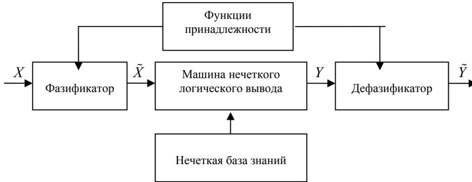
Рис. 1. Нечеткий логический вывод:  $X$  — входной четкий вектор;  $\tilde{X}$  — вектор нечетких множеств, соответствующий входному вектору  $X$ ;  $\tilde{Y}$  — результат нечеткого вывода в виде нечетких множеств;  $Y$  — выходной четкий вектор.
