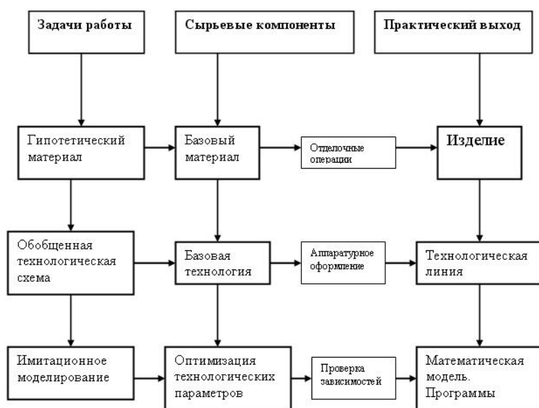
Рис. 1. Схема решения технологических задач при создании новых видов строительных материалов
