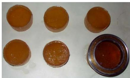
Рис. 2. Образцы-близнецы из желатино-геля ХС, подготовленные для сдвиговых испытаний
