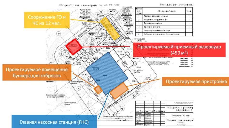
Рис. 2. Схема реконструкции площадки ГНС
