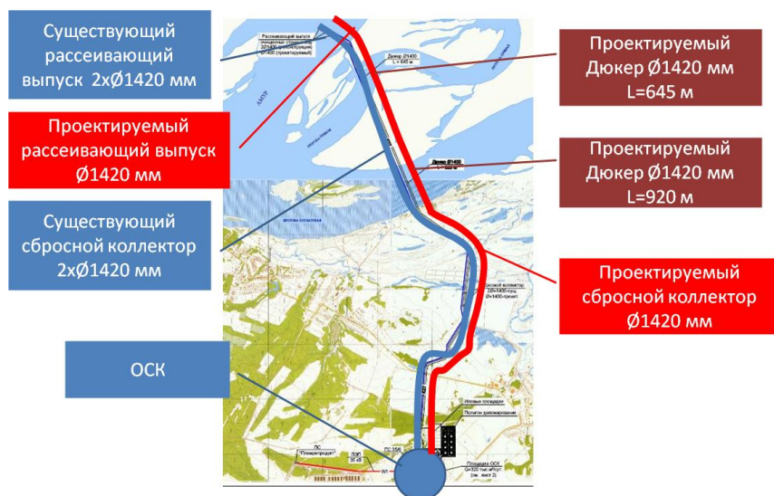
Рис. 12. Схема сбросных коллекторов и выпусков очищенных сточных вод в р. Амур
