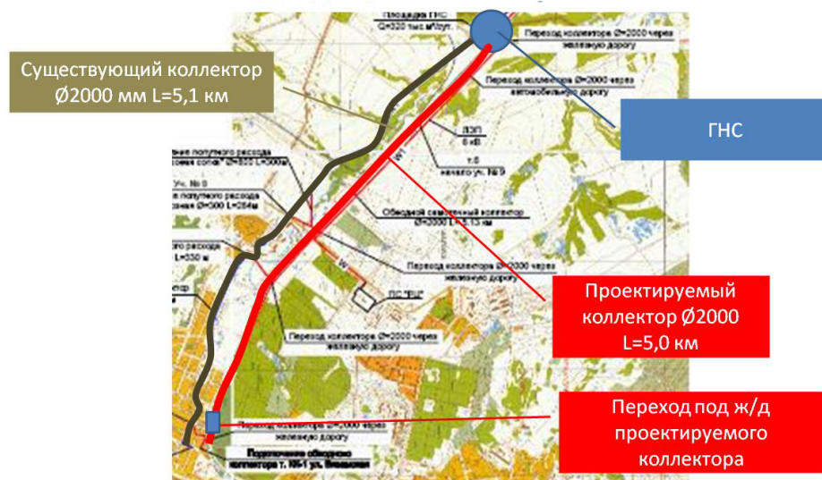
Рис. 1. Схема реконструкции подводящего к ГНС коллектора
