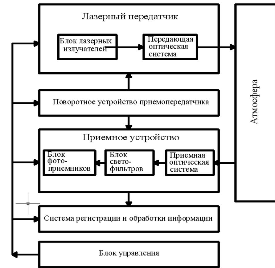
Рис. 1. Структурная схема лазерно-оптического прибора
