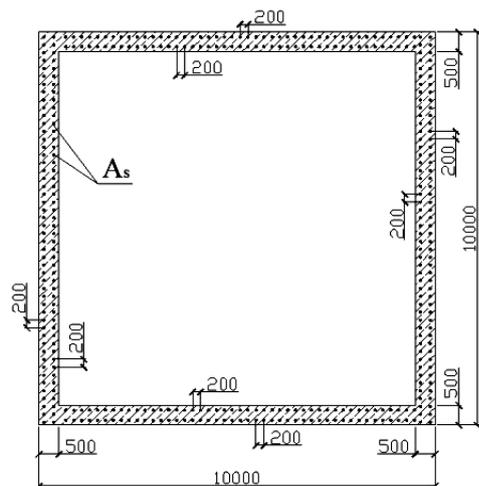
Рис. 2. Сечение железобетонной консоли
