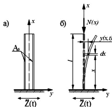
Рис. 1. Консоль: а — схема железобетонной консоли с распределенной массой и жесткостью; б — расчетная схема в системе координат
