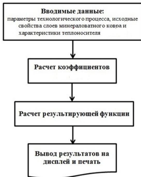
Рис. 2. Алгоритм расчета параметров тепловой обработки минераловатного ковра
