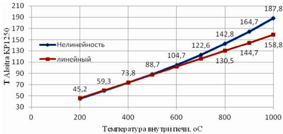
Рис. 11. Сравнение температуры на внутренней поверхности ваты из силиката алюминия Alsitra KR 1250 при линейном и нелинейном расчетах
