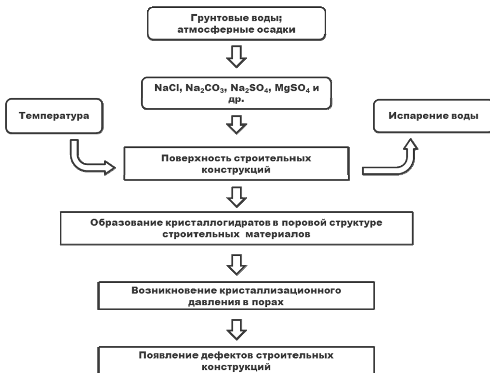
Рис. 1. Особенности коррозионных процессов, происходящих в результате кристаллизации солей
