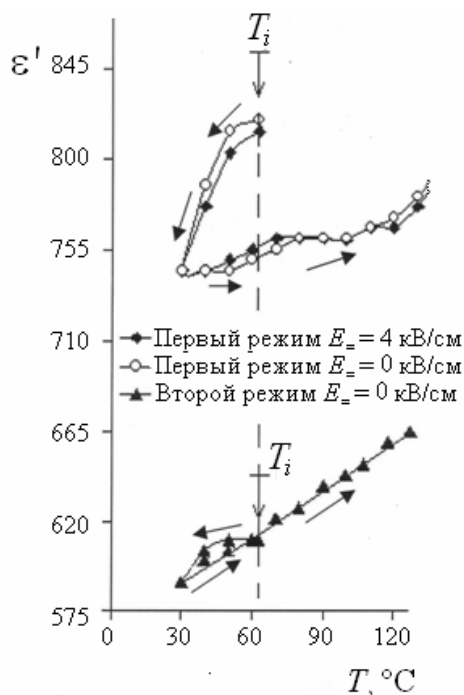
Рис. 4. Температурные зависимости диэлектрической проницаемости \varepsilon'(T) в NNG10 после выдержки образца при T_i = 63^\circ\text{C} для двух температурных режимов, при наличии и отсутствии смещающего поля E_ = 4\text{ кВ/см} на образце. Частота измерительного поля \nu = 1\text{ кГц}
